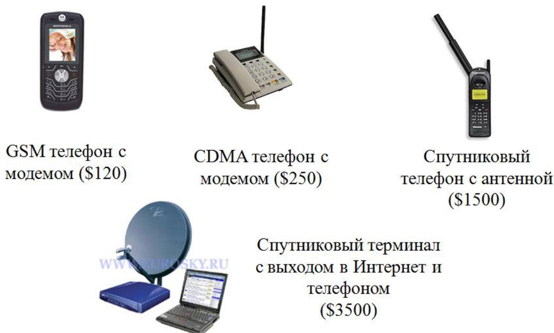
Рис. 5.4. Средства внешней связи поста бурового супервайзера
