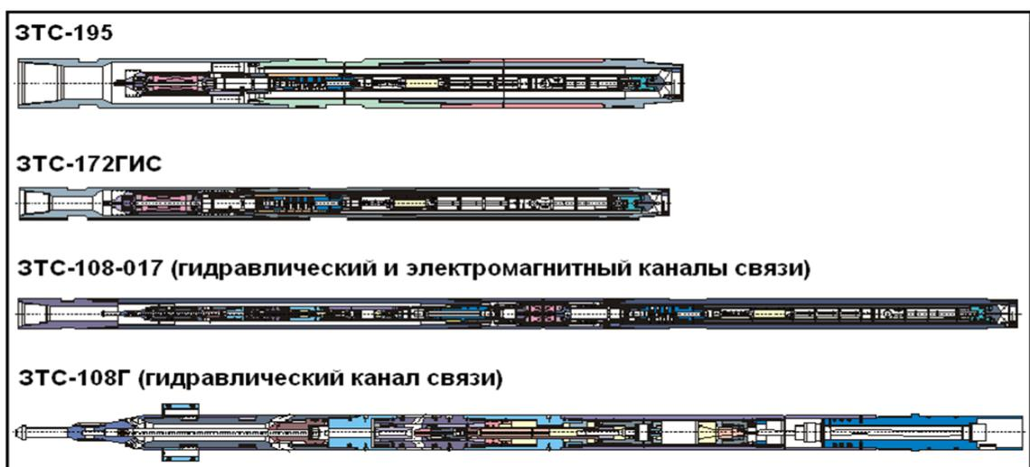
Рис. 3.10. Пример забойных телесистем с различными каналами связи
