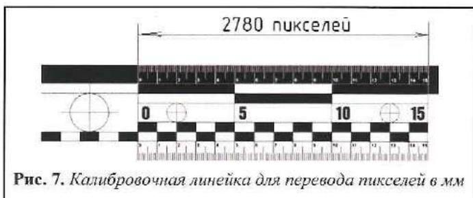
Рис. 7. Калибровочная линейка для перевода пикселей в мм
