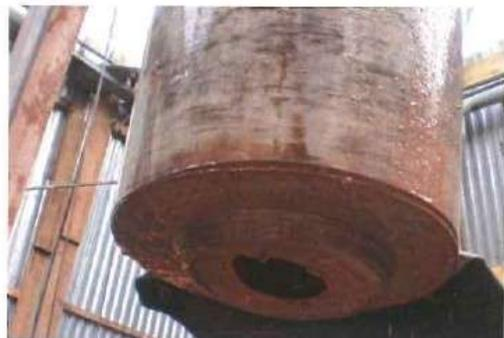
Рис. 1. Слом нитяного бурового инструмента
