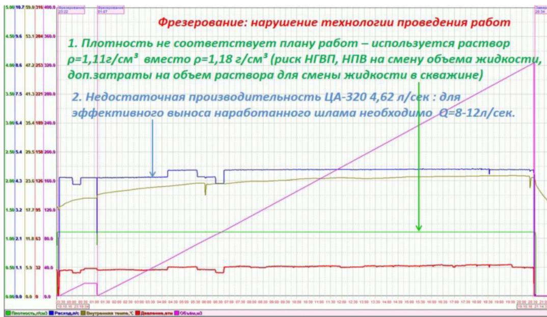
**Рис. 4.** Диаграмма отчета супервайзера – оператора
