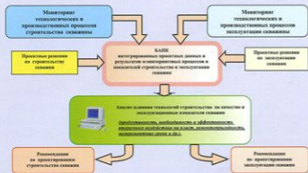
Рис. 4 Информационная система технико-технологического надзора строительства и эксплуатации скважины
